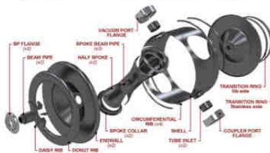
SSR1 Cryomodule FPC
